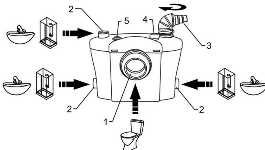
Бытовая канализационная насосная станция UNIPUMP серии SANIVORT 600 предназначена для перекачивания сточных вод, содержащих фекалии. Станция позволяет удалять сточные воды от унитаза, раковин, душевых кабин, находящихся ниже уровня коллектора канализационной системы, а также в удалённых местах, где невозможно или нецелесообразно организовать канализацию самотеком.
